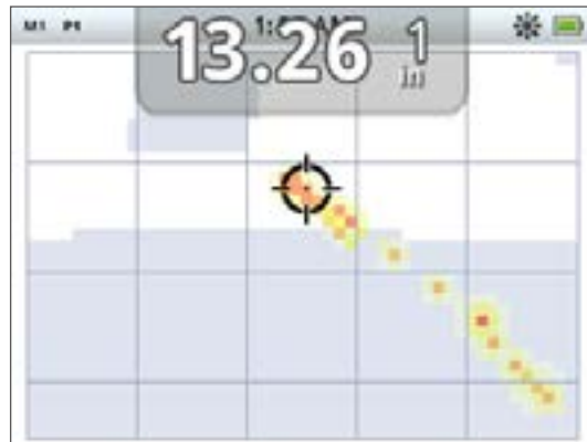
图 11 - 目标追踪显示2个目标(金属钱币和铁钉)
